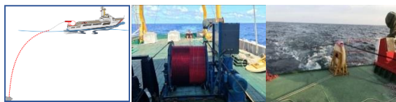
系统示意图、海试中的绞车系统和拖曳链
