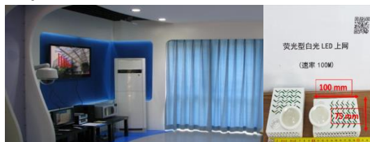
可见光物联网系统实景和可见光上网模块实物
