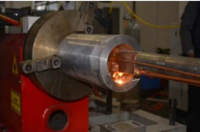
图 3 激光内孔熔覆修复
