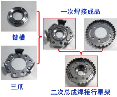
图 1 汽车变速箱行星架激光焊接
